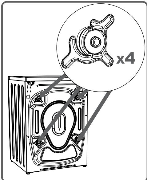
З цієї причини запобіжні транспортні гвинти слід розкручувати шляхом повороту в напрямку проти годинникової стрілки за допомогою відповідного гайкового ключа.
